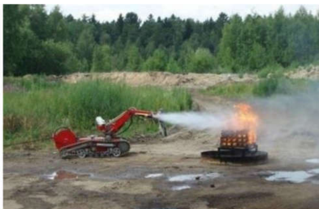
Рис. 2. Подача в очаг возгорания тонкораспыленной воды по рукаву высокого давления
