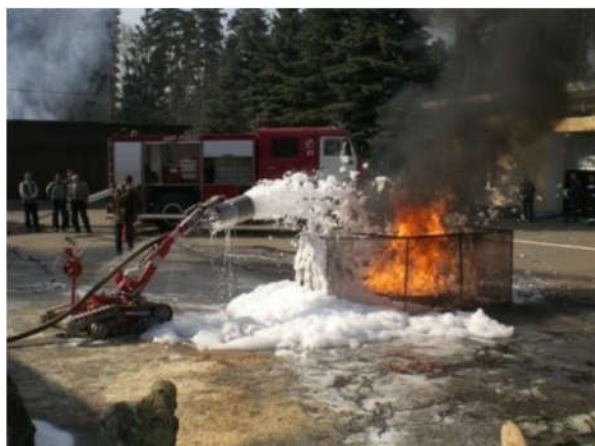
Рис. 2. Подача в очаг возгорания тонкораспыленной воды по рукаву высокого давления
